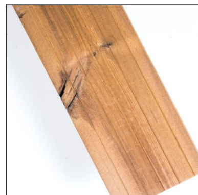
Praskliny kolem suků jsou povoleny
