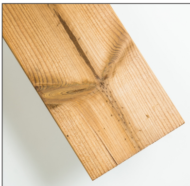
Trhliny na koncích prken jsou povoleny
