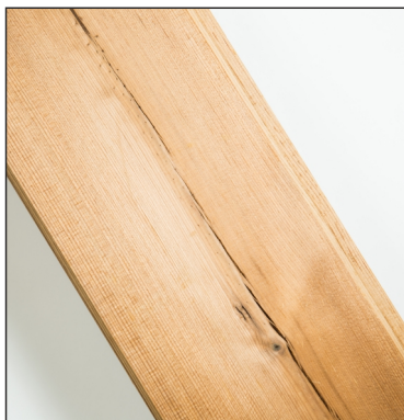
Malé praskliny na povrchu prken jsou povoleny
